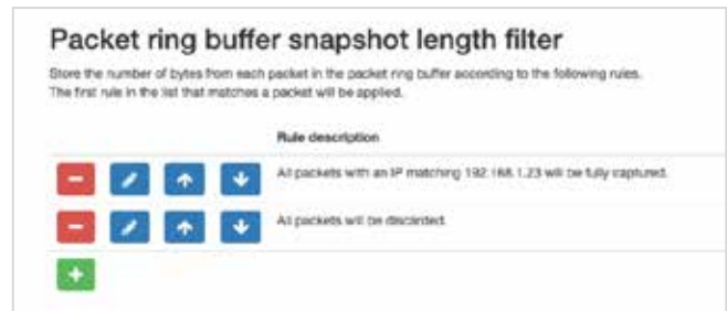
図 6: IP 192.168.1.23 を完全に記録し、その他のパケットを破棄するフィルタルール
